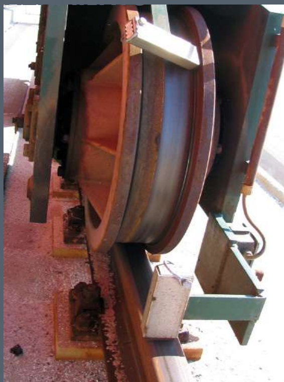
Bloque de adherencia dMT-SPC® tipo MSB-075 montado en el cabezal del raíl
