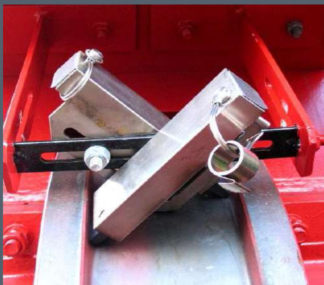
Lubricación de la pestaña de la rueda de una grúa de ferrocarril
