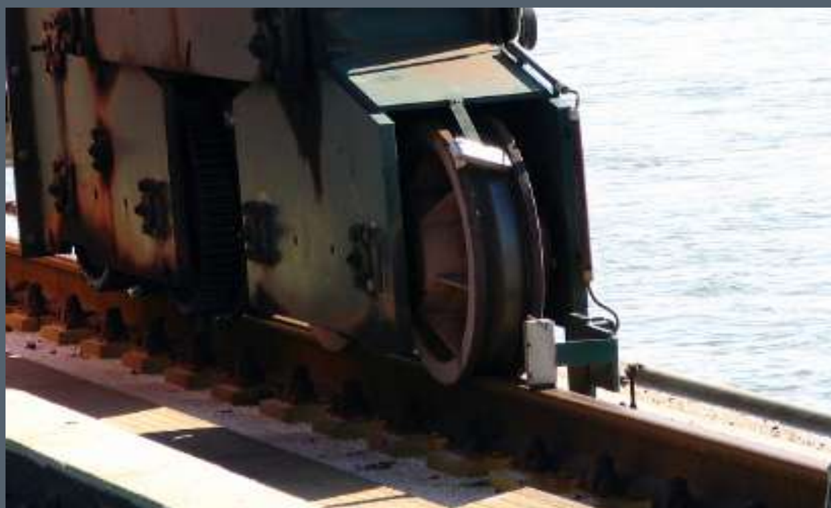
Bloque de adherencia dMT-SPC® tipo MSB-075 montado en la superficie de rodadura
