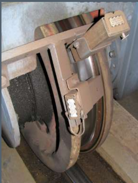
Bloque de adherencia dMT-SPC® tipo MSB-075 montado en la superficie de rodadura
